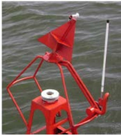
Малюнок 7 Пошкодження антени через зіткнення
