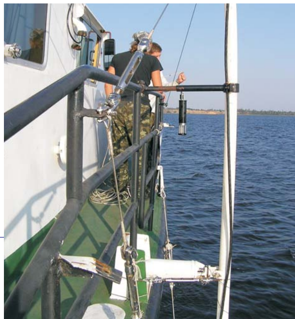
Рис. 5. Вимірювання швидкості звуку у воді датчиком SVP-14
