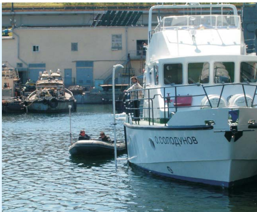
Рис. 1. Штанга для кріплення антен МЛЕ і DGPS-приймача
