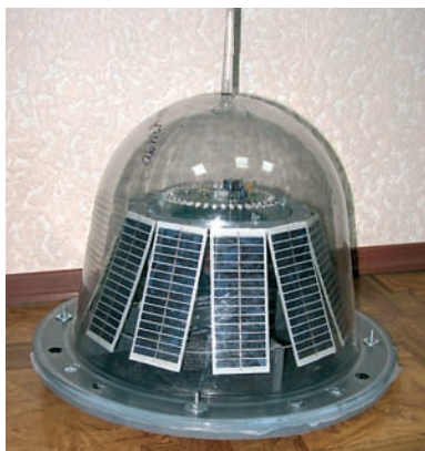
Світлотехнічна головка буя з сонячними панелями та бездротовим програмуванням «Фотон-М-3»
