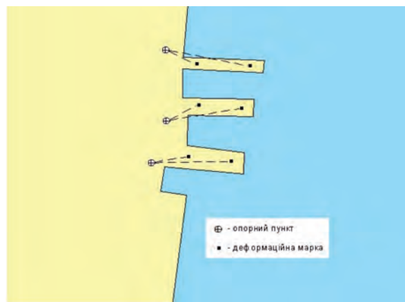
Рисунок 2. Визначення X, Y, H деформаційних марок гідротехнічних споруд відносно опорних пунктів
