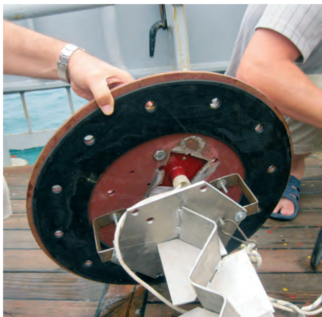
Так виглядає нове кріплення відбивача на голівці буя
