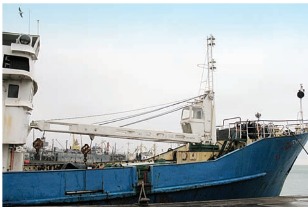
Електромеханічний вантажний кран, встановлений на гідрографічному судні ГС-273 (побудоване у 1968 р.)
