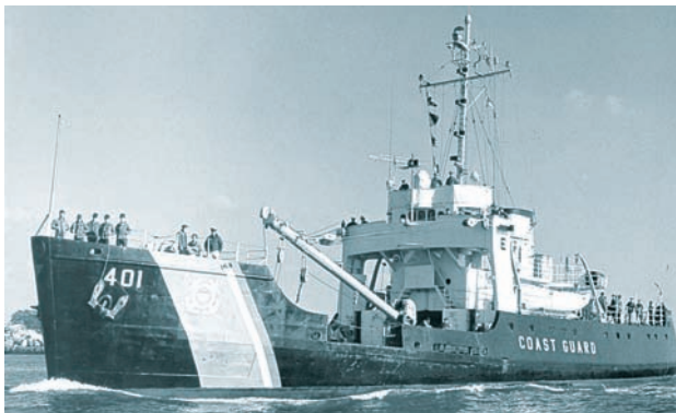
Лоцмейстерське судно з 20-тонною вантажною стрілою (побудоване у США у 1943 р.)
