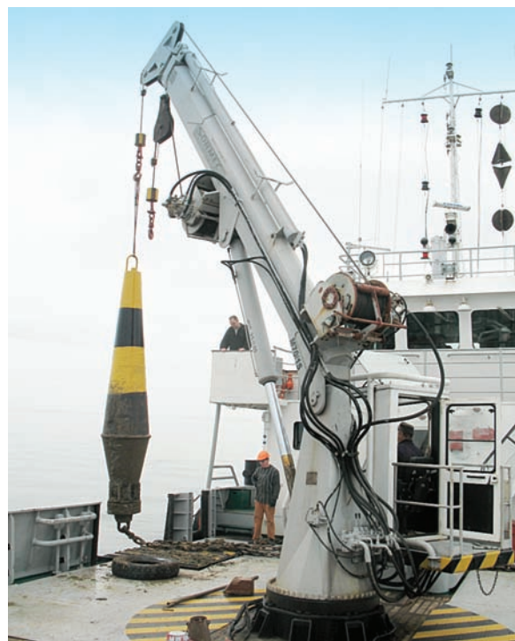
Гідравлічний вантажний кран з телескопічною стрілою, встановлений на сучасному лоцмейстерсько-гідрографічному судні «Одеса», побудованому у 2007 році
