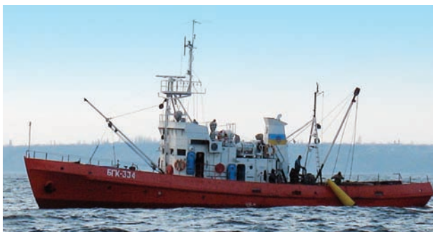
Великий гідрографічний катер «ВГК – 334», обладнаний двома легкими стрілами, під час роботи з бумом
