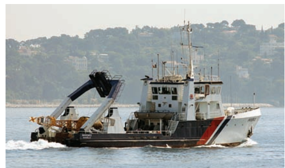
Лоцмейстерське судно, на якому рухомих портал встановлено у кормовій частині (побудоване у 1990 р.)
