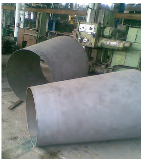
Зачищення секцій корпусу
